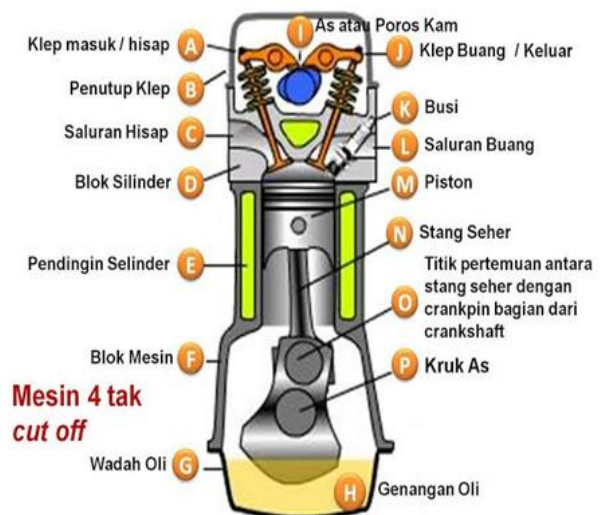
Gambar 2.5 Prinsip Kerja Motor 4 Tak.
